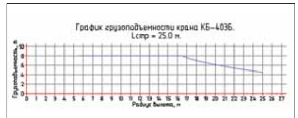
Рис. 9. График грузоподъемности крана, создаваемый программой
